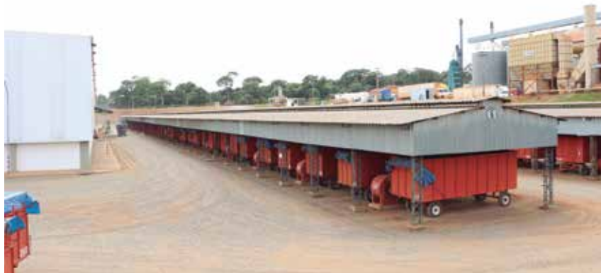
Carretas secadoras do amendoim em vagem
